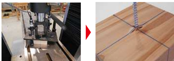
木ネジを打ち込み、それを引っ張り、どれだけの力で抜けるかを確認する試験。
