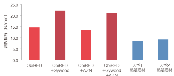
ボルトなどの埋め込み部分から、どれだけ割れが発生しにくいかを確認する試験。左のように加工し、右のように上下に力がかかる。
