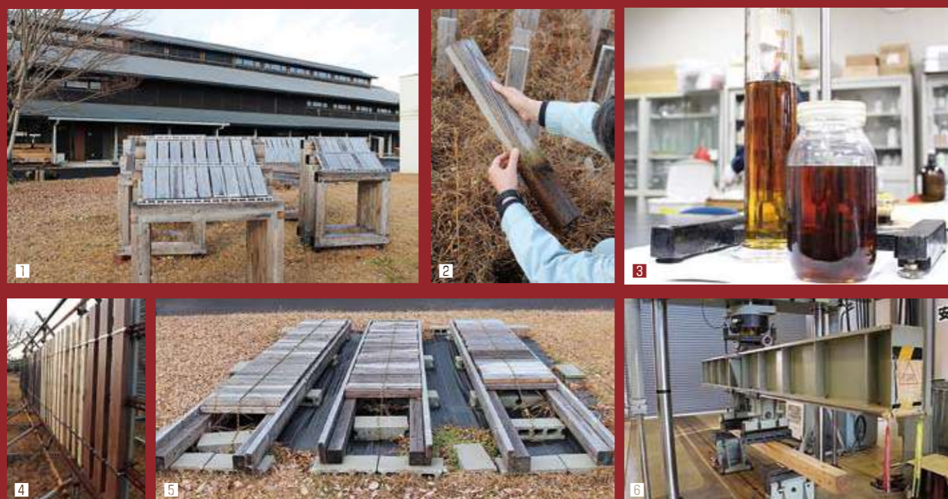
1 宮崎県木材利用技術センターでの直接大気暴露試験（斜め45度） 2 野外杭試験 3 飢肥杉赤身から抽出した精油成分 4 直接大気暴露試験（垂直） 5 ダブルレイヤー試験 6 曲げ強度試験
