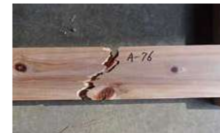
縦引張破壊例
