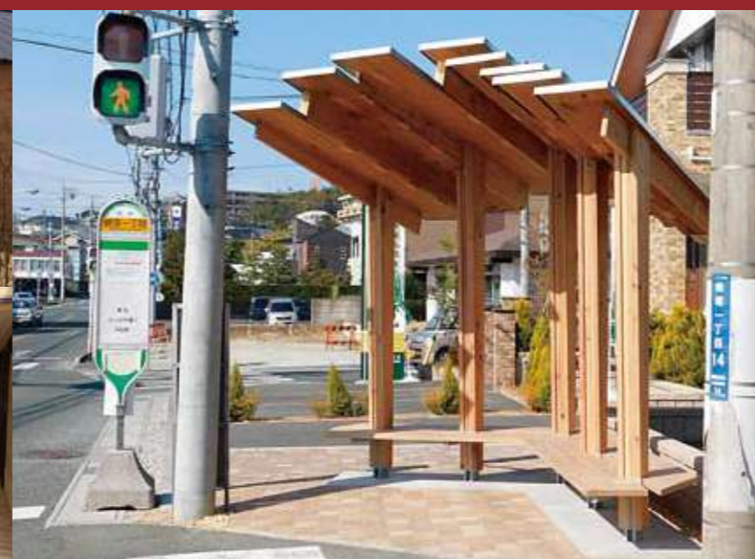
遠鉄バス バス停「蛸塚1丁目」（静岡県） 所在地/静岡県浜松市中区蛸塚1丁目14 商品仕様/ObiRED+AZN デッキ材 クリア塗装 4000×140×40 ObiRED+AZN デッキ材をバス停のベンチに使用。長期防錆・防蟻効果のある材料を屋外用の接着剤で幅はぎ接着し座面に用いています。熱伝導率が低いため、冬は暖かく、夏は暑くなり過ぎないので、優しい座り心地です。
