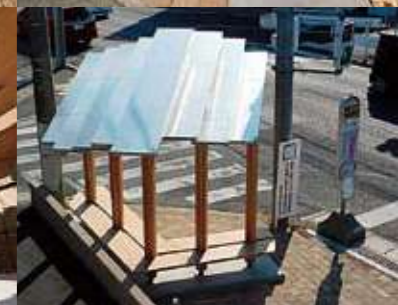
遠鉄バス バス停「蛸塚1丁目」（静岡県） 所在地/静岡県浜松市中区蛸塚1丁目14 商品仕様/ObiRED+AZN デッキ材 クリア塗装 4000×140×40 ObiRED+AZN デッキ材をバス停のベンチに使用。長期防錆・防蟻効果のある材料を屋外用の接着剤で幅はぎ接着し座面に用いています。熱伝導率が低いため、冬は暖かく、夏は暑くなり過ぎないので、優しい座り心地です。
